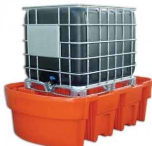
Suoja-allas 1050 L IBC konteille tai esim. polttoainesäiliölle Max kantavuus 2000 kg. Ei ritilää. Mitoitus IBC konteille sopiva.
